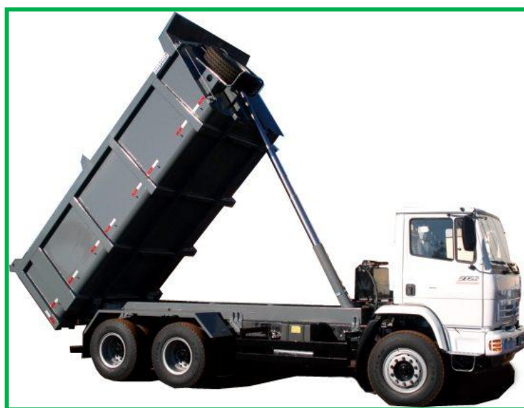
Figura 31 – Caminhão do tipo carroceria fechada – basculante. Fonte: Ideal Consultoria Ambiental e Urbanística LTDA.
